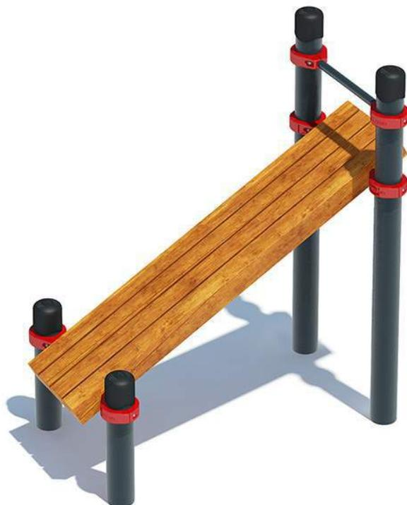
Комплекс состоит из четырех опорных столбов высотой: 2 шт. 1500 мм, 2 шт. 550 мм. Скамья для упражнений на пресс крепится к вертикальным опорным столбам высотой 1500 мм при помощи хомутов на высоте 1050 мм от поверхности резинового основания, к столбам высотой 550 мм на высоте 400 мм. Перекладина для фиксации ног крепиться при помощи хомутов на высоте 1350 мм. Длина комплекса не более 1300 мм.
