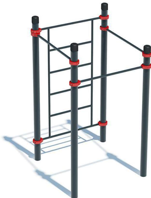
Комплекс состоит из четырех опорных столбов высотой: 3 шт. - 2500 мм, 1 шт. - 2300 мм. Шведская стенка состоит из перекладин, расстояние между которыми 370 мм. Высота шведской стенки 2000 мм. Ширина шведской стенки 1200 мм. Крепится к вертикальным опорным столбам высотой 2500 мм при помощи хомутов на высоте 2450 мм. Перекладины крепятся к опорным столбам при помощи хомутов на высоте: 1 шт. - 2350 мм, 1 шт. - 2200 мм и 1 шт. - 2000 мм, Длина комплекса не более 1450 мм.
