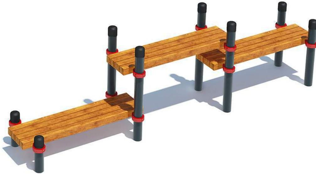
Комплекс состоит из восьми вертикальных опорных столбов высотой: 2 шт. - 450 мм, 2 шт. - 900 мм, 4 шт. - 1200 мм. В комплект входят три скамьи для упражнений шириной 500 мм, которые крепятся к опорным столбам при помощи хомутов на высоте 300 мм, 600 мм и 900 мм соответственно. Длина комплекса не более 4400 мм.
