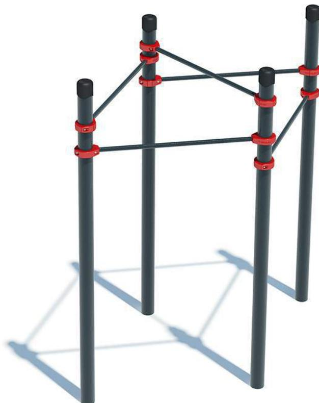
Комплекс состоит из четырёх вертикальных столбов высотой 2500 мм и пяти перекладин для подтягивания длиной 1200 мм. Перекладины крепятся к опорным столбам при помощи хомутов на высоте: 2400 мм, 2300 мм, 2100 мм, 1900 мм. Длина комплекса не более 2400 мм.
