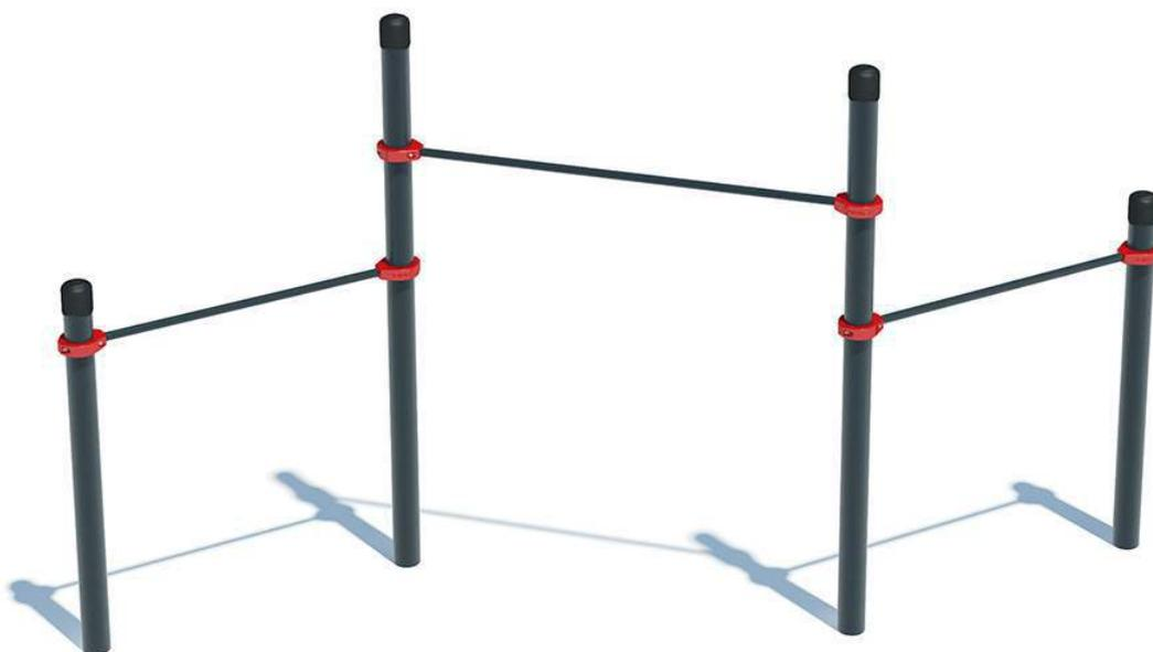
Комплекс состоит из четырех вертикальных опорных столбов высотой 2 шт. 2300 мм, 2 шт. 1500 мм. и трех горизонтальных перекладин для подтягивания длиной 2 шт. - 1200 мм и 1 шт. 1700 мм. Перекладины крепятся к опорным столбам при помощи хомутов на высоте: 2 шт. - 1300 мм и 1 шт. - 1800 мм, Длина комплекса не более 4100 мм.
