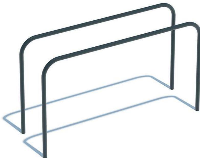
Брусья расположены параллельно. Расстояние между двумя внутренними поверхностями жердей 500 мм. Рабочая поверхность жердей 1800 мм. Жерди брусьев симметрично изогнуты под углом 90 градусов и представляют собой конструкцию высотой 1200 мм от поверхности резинового основания. Длина комплекса не более 2100 мм.
