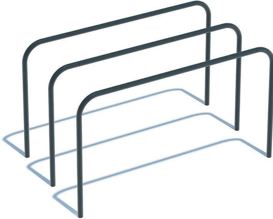
Брусья расположены параллельно. Расстояние между двумя внутренними поверхностями жердей 500 мм. Рабочая поверхность жердей 1800 мм. Жерди брусьев симметрично изогнуты под углом 90 градусов и представляют собой конструкцию высотой 1200 мм от поверхности резинового основания. Длина комплекса не более 2100 мм.
