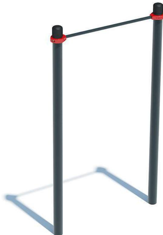
Турник состоит из двух вертикальных опорных столбов высотой 2500 мм и горизонтальной перекладины длиной 1200 мм. Перекладина фиксируется хомутами на высоте 2400 мм. Длина комплекса не более 1450 мм.
