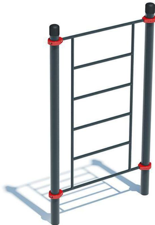
Комплекс состоит из двух вертикальных опорных столбов высотой 2500 мм, и шведской стенки. Шведская стенка состоит из перекладин, расстояние между которыми 370 мм. Высота шведской стенки 2000 мм. Ширина шведской стенки 1200 мм. Крепится к вертикальным опорным столбам при помощи хомутов на высоте 2450 мм. Длина комплекса не более 1450 мм.
